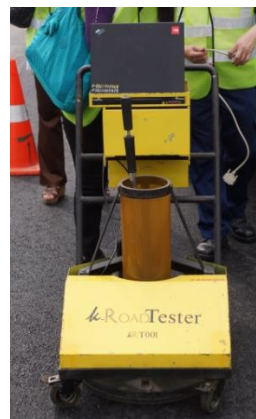
(d) NUS k-permeameter for measurement of permeability
